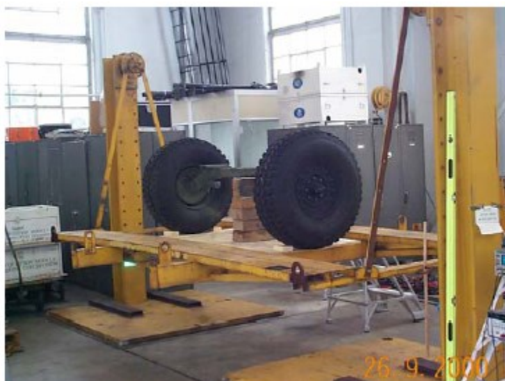
OBRÁZEK H.5 – Měření momentu setrvačnosti kola a nápravy
