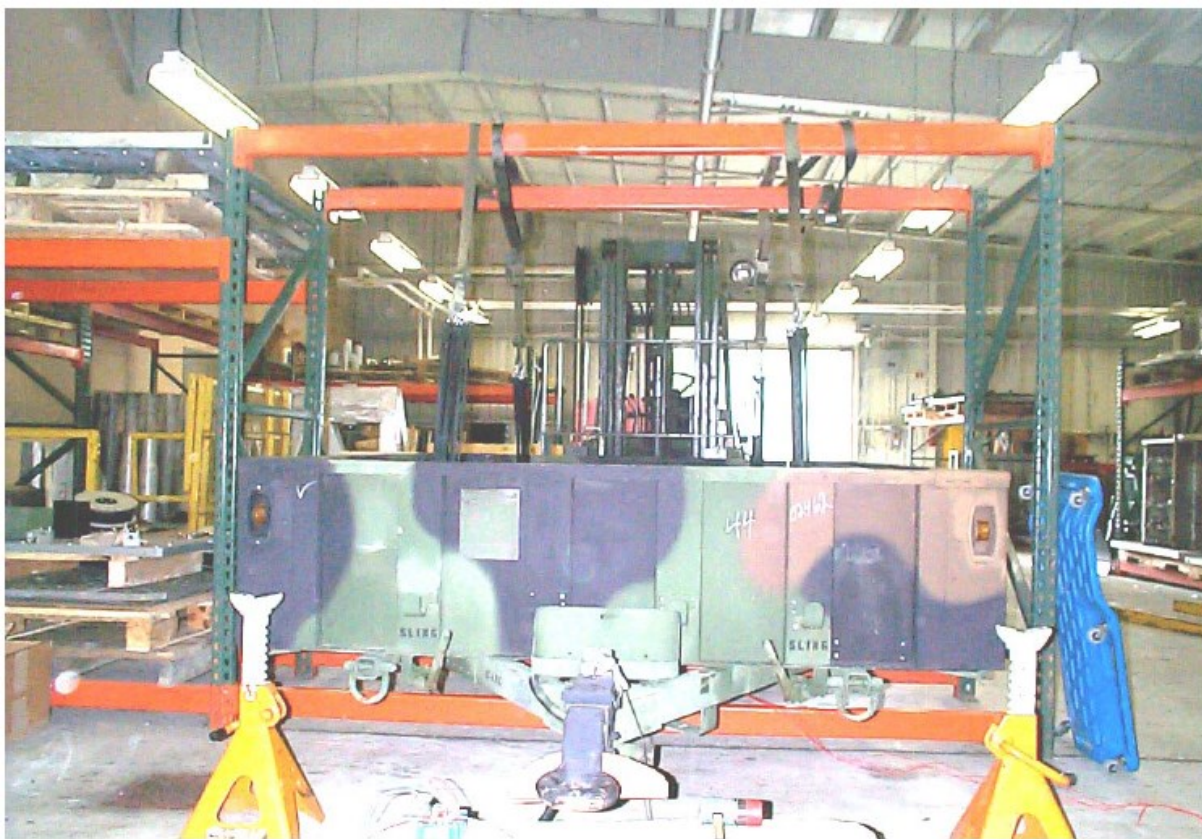
OBRÁZEK H.8 – Uspořádání experimentální modální analýzy ukazuje pružná závěsná lana a rázové kladivo
