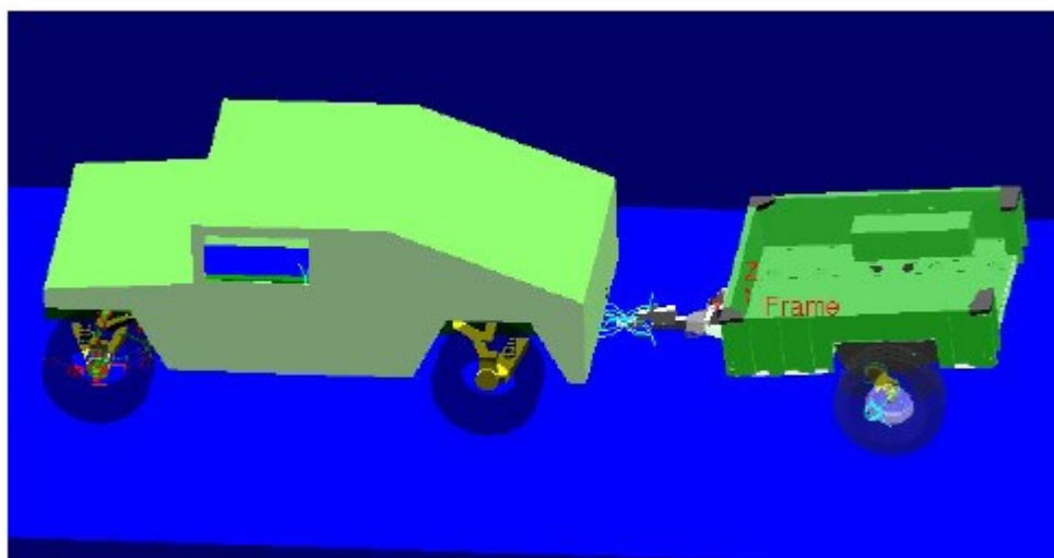
Obrázek H.3 – Kombinovaný dynamický model tažného vozidla a přívěsu s mnoha tuhými tělesy
