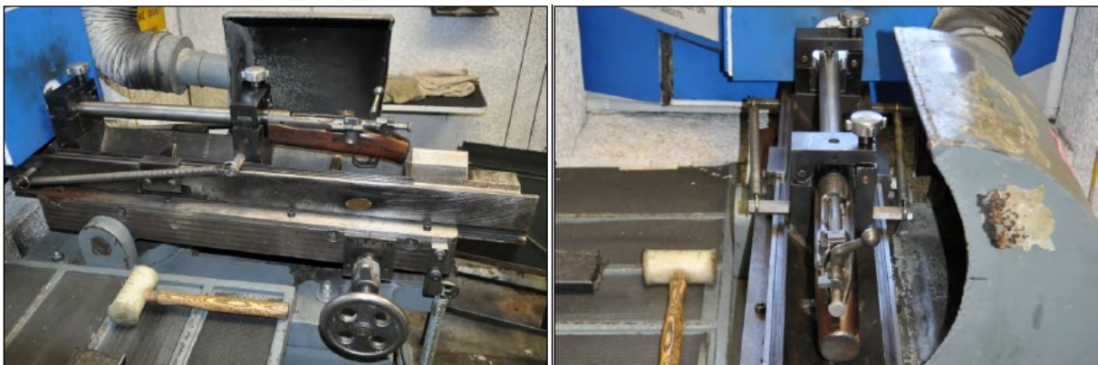
Obrázek 6-B.9 - Dva pohledy na zkoušku přesnosti ráže 7,62 mm
