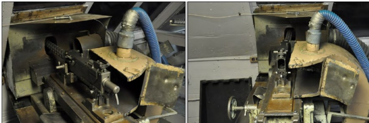
Obrázek 6-B.13 - Dva pohledy na sestavu zkoušky stopovky ráže 7,62 mm s kulometem T65E1
