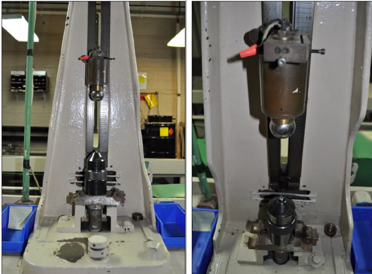
Obrázek 6-B.14 - Dva pohledy na přípravek pro zkoušení citlivosti zápalky
