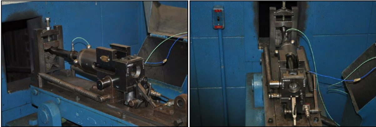
Obrázek 6-B.1 - Dva pohledy na sestavu pro zkoušku EPVAT 5,56 mm
