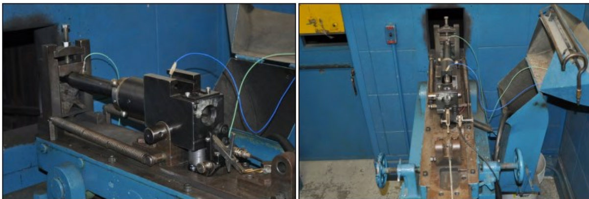
Obrázek 6-B.2 - Dva pohledy na sestavu pro zkoušku EPVAT 7,62 mm
