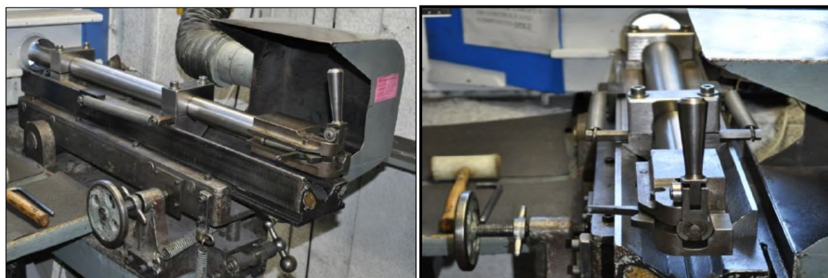
Obrázek 6-B.11 - Dva pohledy na zkoušku přesnosti ráže 12,7 mm
