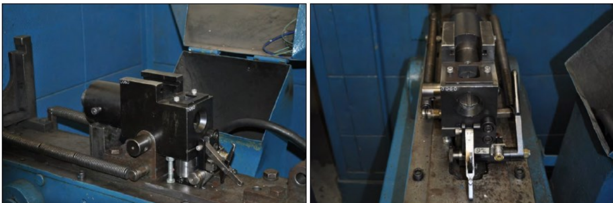
Obrázek 6-B.3 - Dva pohledy na sestavu pro zkoušku EPVAT 4,6 mm, 5,7 mm, a 9 mm
