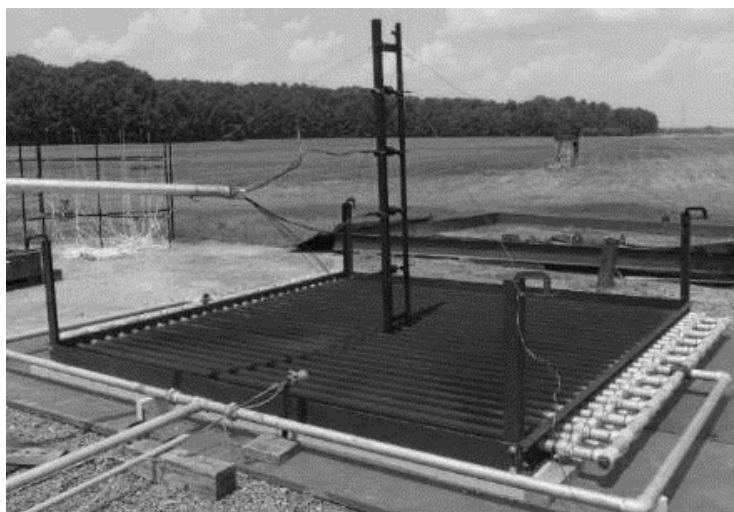
OBRÁZEK 8 – Vertikální vzpěra pro měření tepelného toku
